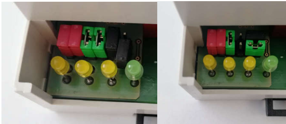
Abb. 8: Aufbewahrung von einem oder zwei Jumpern zum Schutz gegen Verlust
